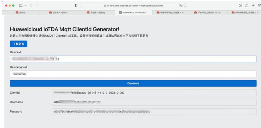
添加订阅发布后，将参数一并填写入模组中（记得替换通配符），保存重启设备。
