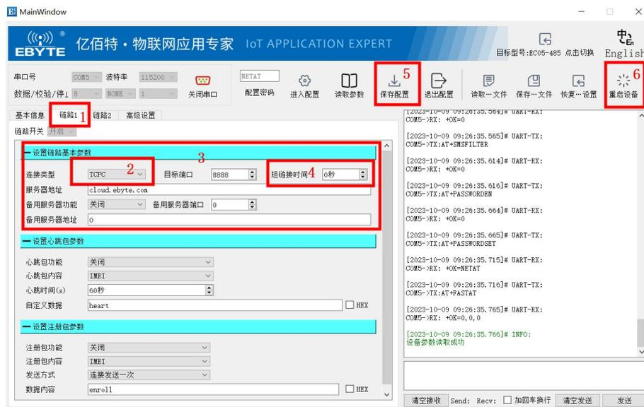
模组入网后即可自动连接到设置的服务器。
