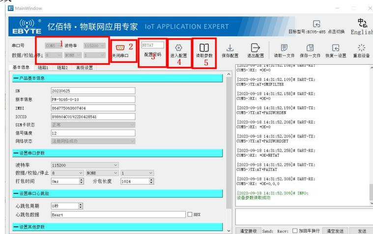
6. 选择“链路1”，配置链路“连接类型”，此处以TCP（TCP客户端）为例；
