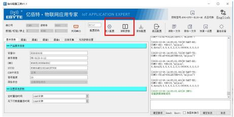
第五步:配置通道 1 参数,选择通道 1 配置为 TCP/UDP 透传,选择连接类型为 TCPC,确认目标服务器参数,目标地址与目标端口。(默认为亿佰特测试服务器,IP 地址: cloud.ebyte.com,端口:8888),完成后点击保存配置、重启设备。
