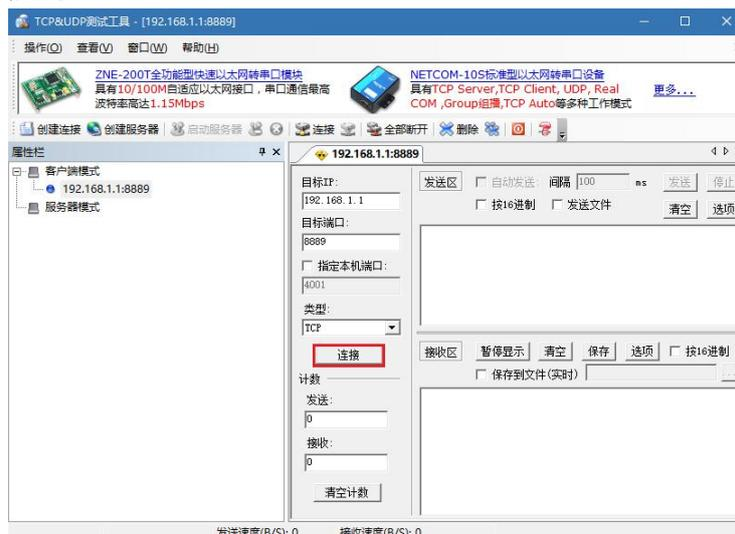
③. 模块底板 LED2 灯常亮（GPIO10 拉低），表明完成连接，就可以完成 PC 机与模块双向传输数据了（即 TCP&UDP 测试工具与串口调试助手双向通信了），否则请重新操作以上步骤。
