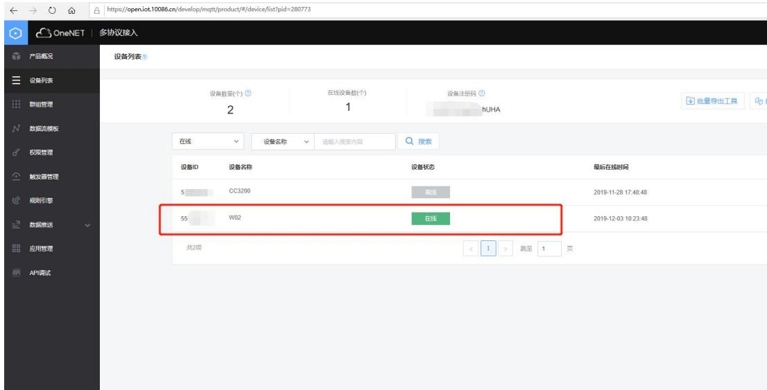
此时，当成功接入 ONENET 后，此时 GPIO10 管脚被拉低，用以表征接入成功的状态，掉线则会拉高。为了直观的演示设备数据的传输过程，我们使用另一台W02 按照上述的步骤进行（注意订阅与上报的路径需要交换一下）
