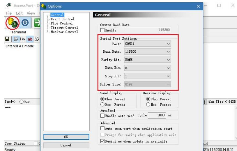
④. 下面我们进入 AT 指令模式进行简单配置。（由于我们发送的是指令，为了更好的进行调试请将串口的实时发送（Real Time Send）功能关闭；若你用的串口调试助手没有实时发送功能请忽略此条）
