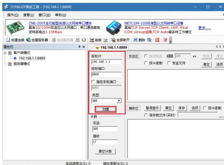
⑦. 创建成功，就可以完成 PC 机与模块双向传输数据了（即 TCP&UDP 测试工具与串口调试助手双向
