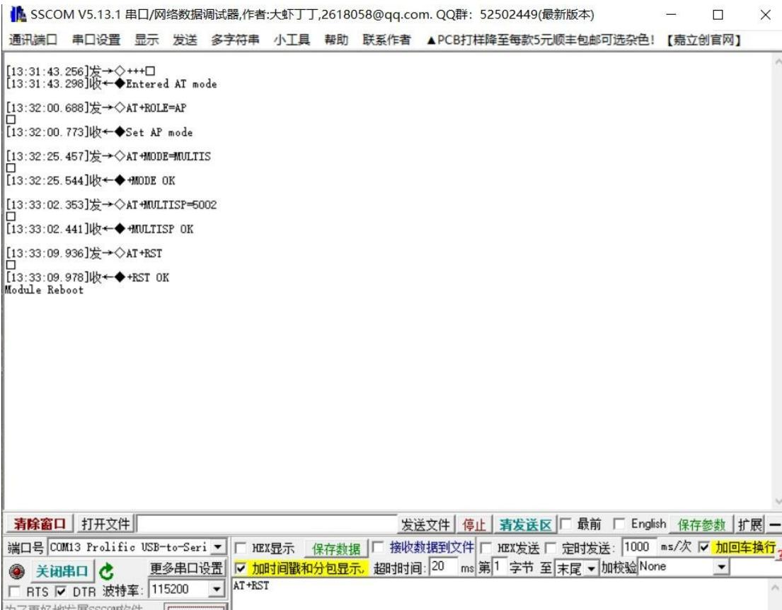
重启后, 此时, 模块工作在MULTIS 模式, 服务器开机之后, 就已经建立起来, 端口号与本地IP 由用户自定义设置。使用电脑连接模块的 SSID, 是电脑端与模块处于同一个局域网, 当电脑成功连接模块后, 此时 GPIO9 管脚被拉低。
