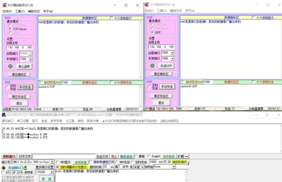
当串口发送数据时，以广播的形式发送至模块客户端所连接的每一路服务器上，每一路服务器发送的数据均打印至模块串口。
