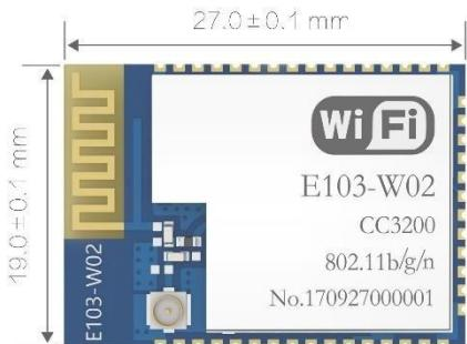
E103-W02 模块支持标准的 IEEE802.11b/g/n 协议和完整的 TCP/IP 协议栈，支持 STA/AP 网络角色、支持多种网络工作模式，支持 SmartConfig、串口透传、开机透传等功能，简单配置后便可以非常便利的实现网络访问功能，最大限度减少开发者的工作和项目开发时间。
