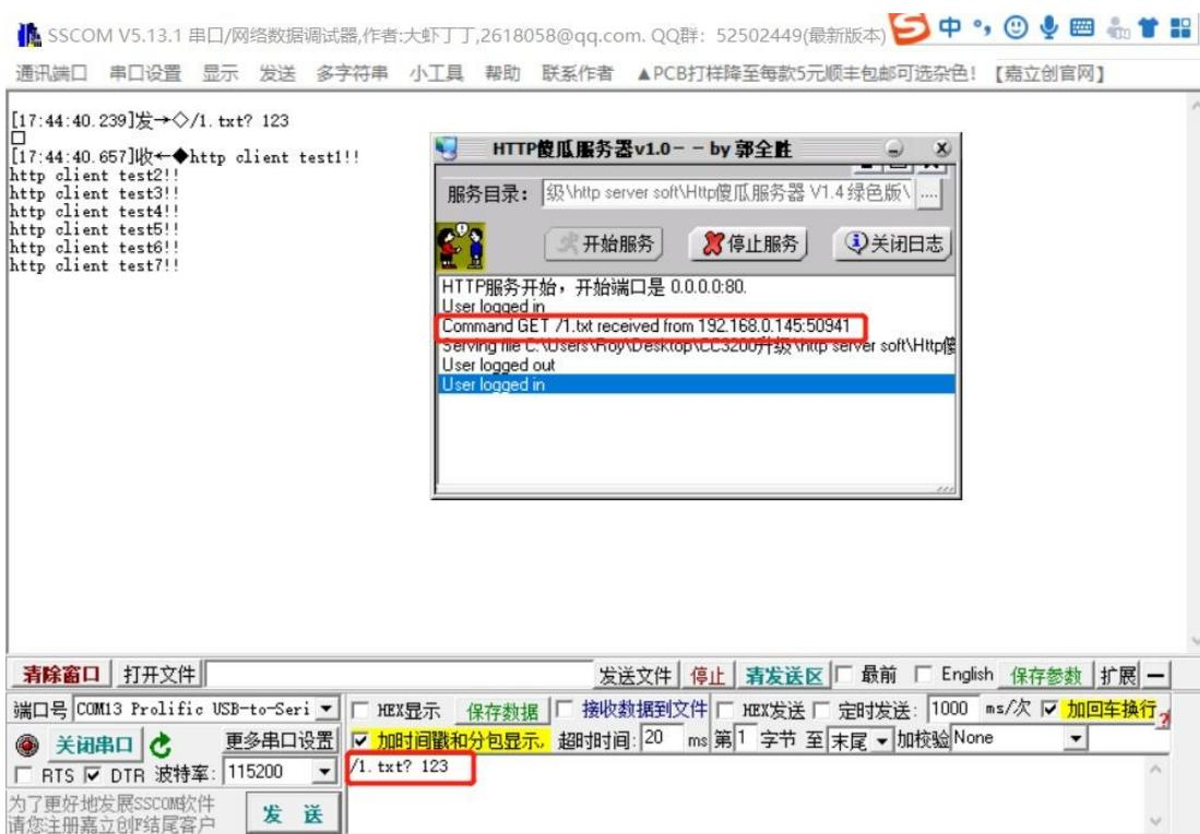
在上图中，能看到服务器解析的请求方式与路径，以及在使用GET 方式时，需要在串口数据中去指定访问的路径（记得加“？”与空格哦）
