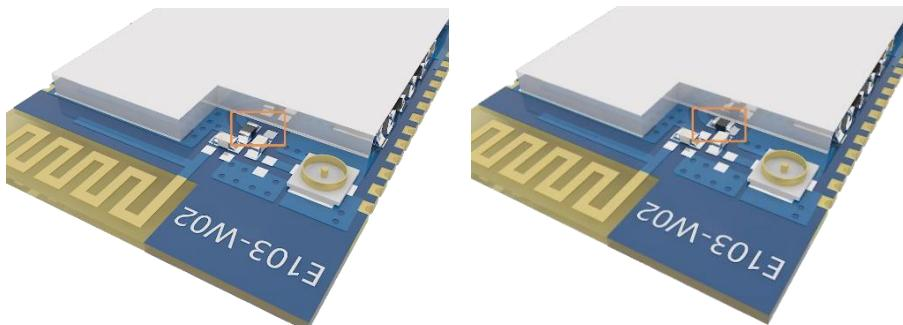
出厂 OR 电阻默认焊接如上图（左）所示，天线接口方式为PCB；如需要把天线接口方式改成 IPEX，请将 OR 电阻改成如上图（右）所示。
