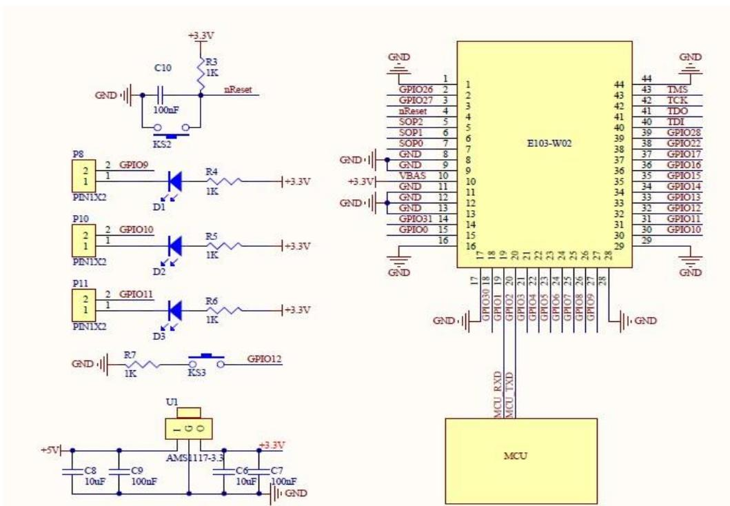
注意：供电电源必须保证在 2.4V~3.6V，为保证模块能稳定工作，建议外部选择电流大于 500mA 的LDO。
