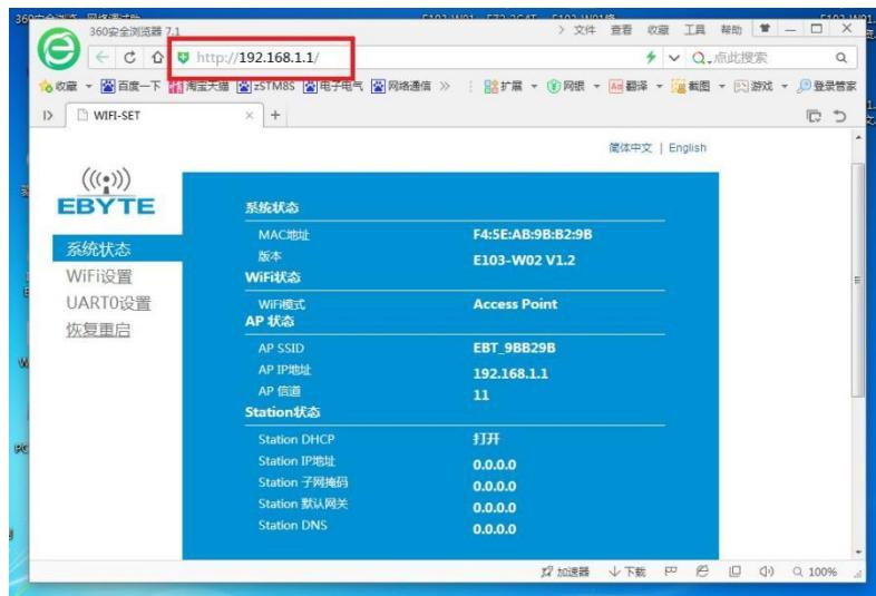
然后进入模块参数配置页面，在此页面上可以对模块的多个参数进行重新设置，
