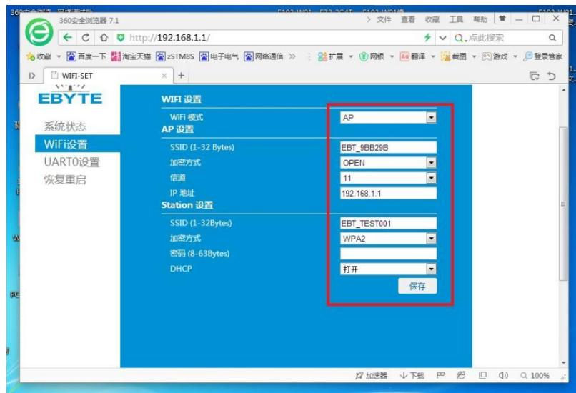
参数重新配置好过后，模块需重新启动，配置参数方能生效。
