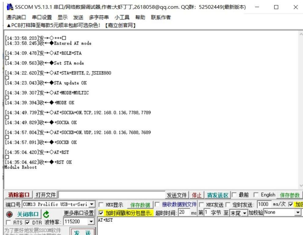
若建立 2 个链路以上且链路具有 TCP 类型的链路，在模块重启之前，需要保证服务器（TCP）已经被建立，原因后面的注意事项中会解释，正常情况下，本地的TCP 服务器与UDP 服务器均被模块的 A B 2 路客户端
