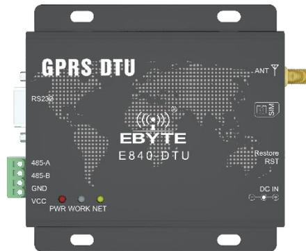
E840-DTU (GPRS-03) 是为实现串口设备与网络服务器，通过网络相互传输数据而开发的产品，该产品使用亿佰特标准 AT 指令，可实现设备与服务器之间进行透明传输，搭配云平台，可以实现自由组网模式。E840-DTU (GPRS-03) 是一款工业级的四频段 GSM/GPRS 数传电台。
