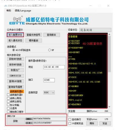
3. 进入 4G/2G 网络透传配置模式后,即可在"相关参数设定"框中配置 4G/2G 模块的参数,配置完成后,点击"保存 NET 参数"按钮,上位机将提示"保存所有参数成功"。完成后如下图所示:
