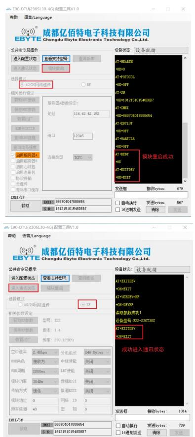
6. 进入通讯状态后,30 秒内,若 LINK 指示灯常亮表示已接入服务器,此时便可以进行网络透明传输。
