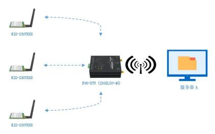
(2) E90-DTU(230SLxx) + E90-DTU(230SL30-4G) + 服务器 A
