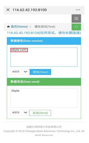
(b ) E90-DTU (230SL30-4G) 接收到服务器发送的数据,再将数据发送至 E22-230TXXS
