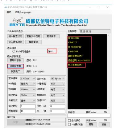
5. 模块参数配置完成后,若修改了"4G/2G 网络透传"模式下的参数,需再次 "4G/2G 网络透传"模式,点击"公共命令及提示"框中的"模块重启"按钮,让修改的4G/2G 参数生效且自动进入通讯状态;若没有修改"4G/2G 网络透传"模式下的参数,则无需点击"模块重启"按钮,在RF模式下直接点击"进入通讯状态"按钮。完成后如下图所示:
