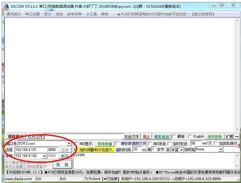
2、将设备 A 和设备 B 的 SOCKET A1 网络类型设置为 TCP Server，本地端口 8886。点击保存，重启模块。
