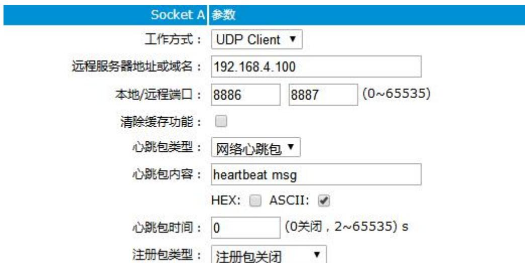
3、如下图所示，网络调试助手连接到 DTU 设备进行通信测试。
