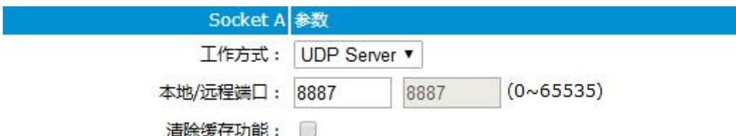
3、如下图所示，网络调试助手连接到 DTU 设备进行通信测试。
