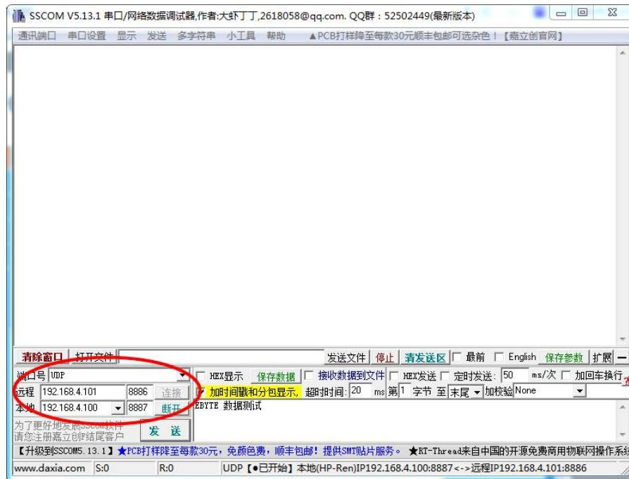
2、将设备 A 和设备 B 的 SOCKET A1 网络类型设置为 UDPC (UDP Client) , 目标 IP 为 192.168.4.100, 目标端口 8887。点击保存，重启模块。
