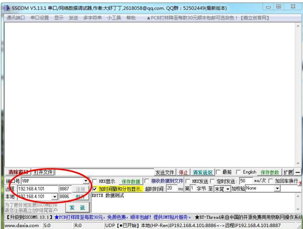
2、将设备 A 和设备 B 的 SOCKET A1 网络类型设置为 UDPS (UDP Server)，本地端口 8887。点击保存，重启模块。
