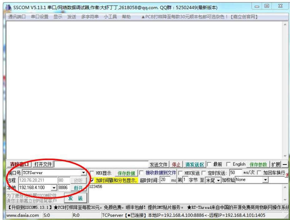
2、将设备 A 和设备 B 的 SOCKET A1 网络类型设置为 TCP Client，目的 IP 为 192.168.4.100，本地端口 0（随机端口），目的端口 8886。点击保存，重启模块。
