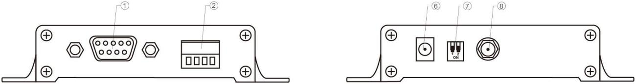
用户可以选择 ⑥ DC 电源接口供电，使用接口为外径 5.5mm、内径 2.5mm 电源适配器供电；亦可 ② 中的 VCC 端子与 GND 端子供电，只用选择任意其一供电方式即可；E90-DTU 可以使用 10~28V 直流电源供电，推荐使用 12V 或 24V 直流电源。
