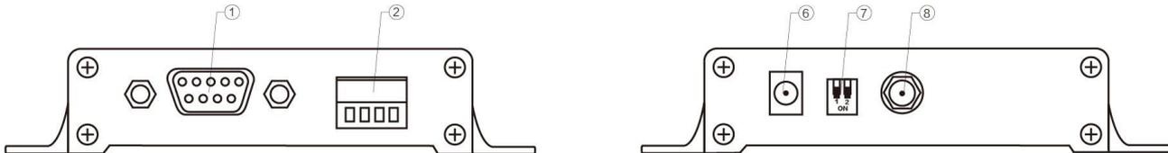
用户可以选择 ⑥ DC 电源接口供电，使用接口为外径 5.5mm、内径 2.5mm 电源适配器供电；亦可 ② 中的 VCC 端子与 GND 端子供电，只用选择任意其一供电方式即可；E90-DTU 可以使用 10~36V 直流电源供电，推荐使用 12V 或 24V 直流电源。
